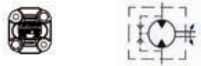
Drainage intérieur - Code F
