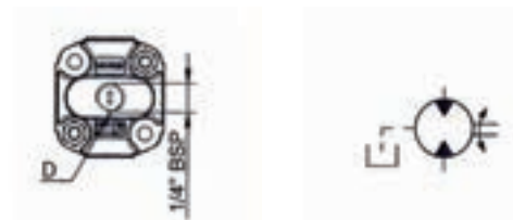
Drainage extérieur - Code E
