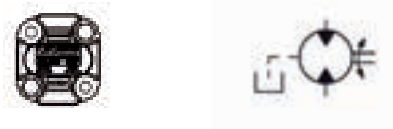
Drainage sur la base - Code P
