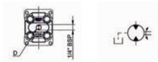
Drainage extérieur - Code E
