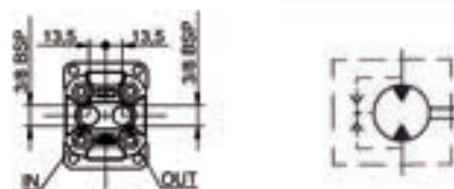
IN + OUT + Drainage intérieur - Code L
