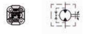
Drainage intérieur - Code F
